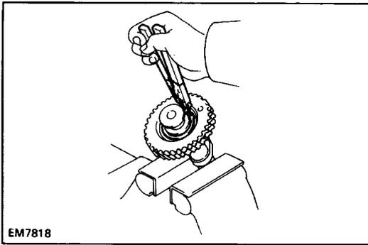
(d) Using snap ring pliers, remove the snap ring.
