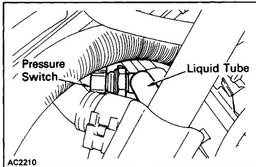
**1. DISCONNECT CONNECTOR OF PRESSURE SWITCH**
