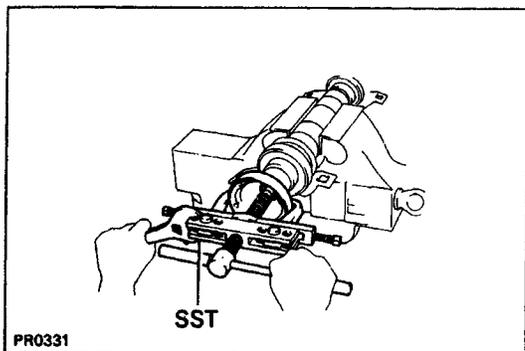
(d) Using SST, remove the rear flange.
