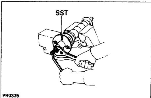
(d) Using SST, remove the flange.
