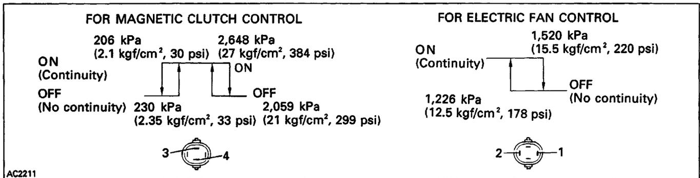
**INSPECTION OF A/C ENGINE COOLANT TEMPERATURE SWITCH**
