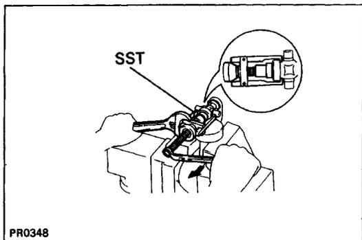
(d) Using SST, install new bearings on the spider.
