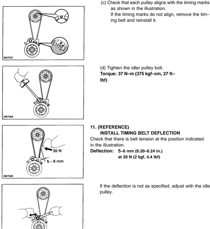
(d) Tighten the idler pulley bolt. Torque: 37 N-m (375 kgf-cm, 27 ft-
