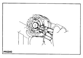
(d) Using snap ring pliers, remove the snap ring.
