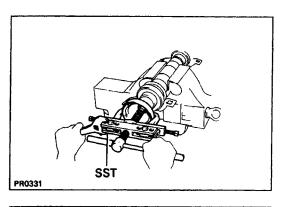
(d) Using SST, remove the rear flange. SST 09950–20017
