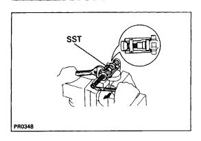
(d) Using SST, install new bearings on the spider. SST 09332–25010
