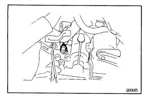
15. CONNECT BACK –UP LIGHT SWITCH CONNEC– TOR
