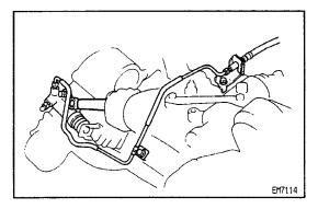
**18. INSTALL CLUTCH RELEASE CYLINDER**
